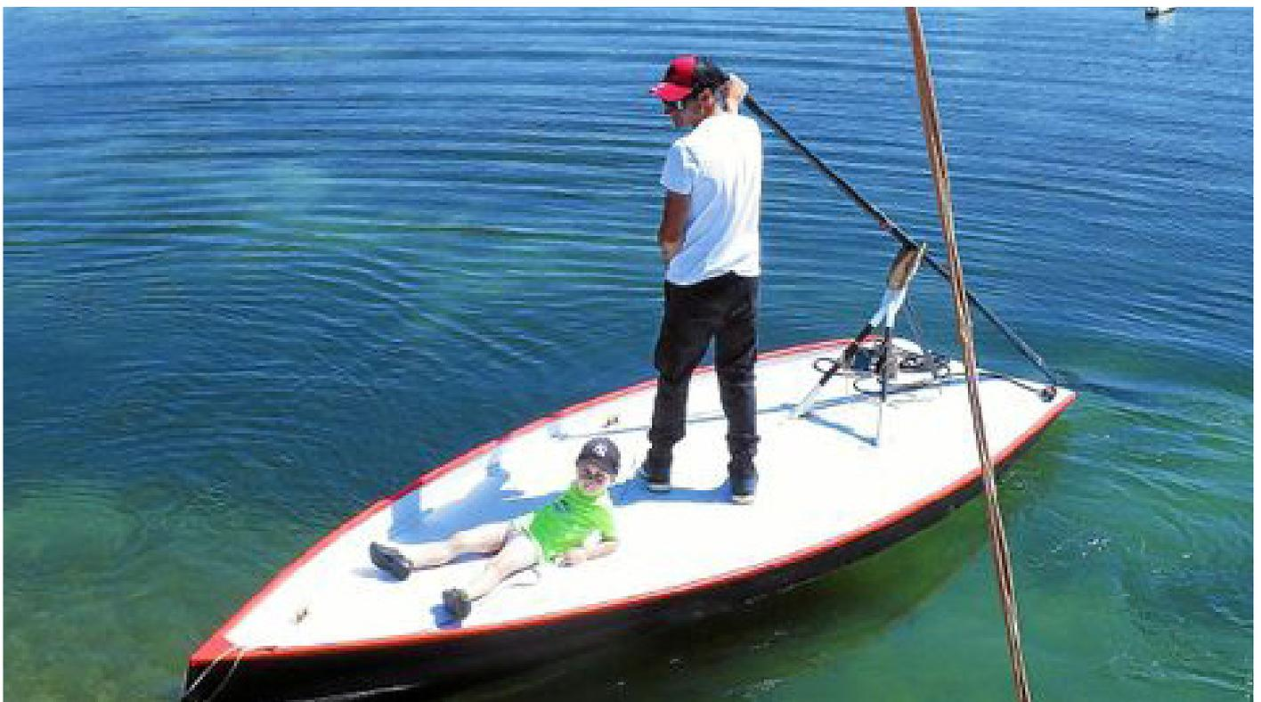
**Lors d'un moment de pose, Eric Arzel et son fils vont essayer un nouveau prototype spécifique à la godille. Il n'y a pas de dame de nage. L'engoujure est surélevée sur un trépied de manière à faciliter la rotation de la godille**
